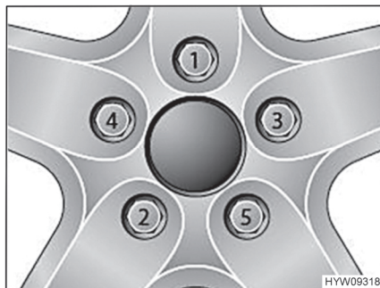
Fig. 90 Apretar las tuercas o los tornillos de las ruedas en forma de cruz
