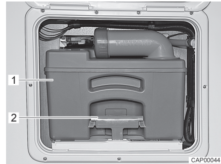
Fig. 85 Depósito de aguas fecales
