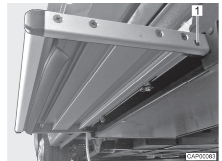
Fig. 87 Tope (escalón de entrada)
