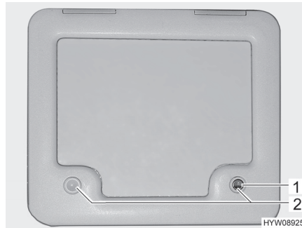
Fig. 84 Trampilla para el depósito de aguas fecales
